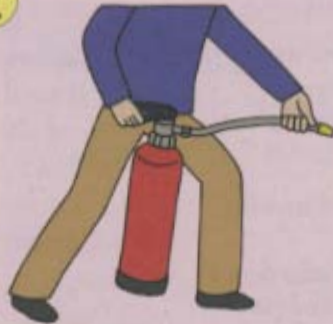
ดึงสาย และเอาหัวดับเพลิงชี้ไปทางที่เกิดไฟไหม้
